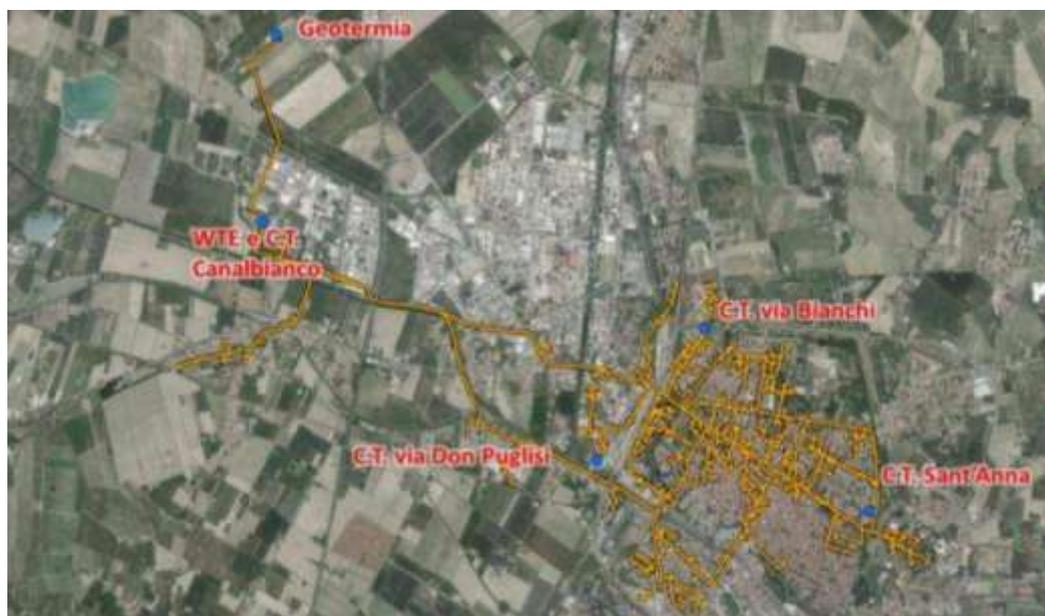
Figura 95 Inquadramento del sistema TLR di Ferrara – Assetto attuale – Fonte: Hera
