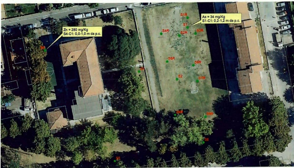
In **Figura 2** si riporta una planimetria del progetto di intervento con sovrapposta l'ubicazione dei sondaggi realizzati
