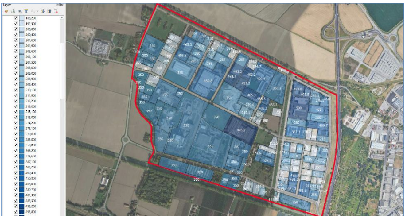
Fig. 83 –Volume di accumulo e laminazione specifico
