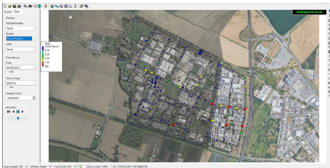
Fig. 65 – Nodi idraulici nei quali si potrebbe verificare il fenomeno del “flooding”
