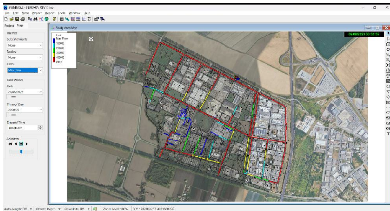
Fig. 56 – Rete fognaria – Portate massime nei singoli rami (l/s)
