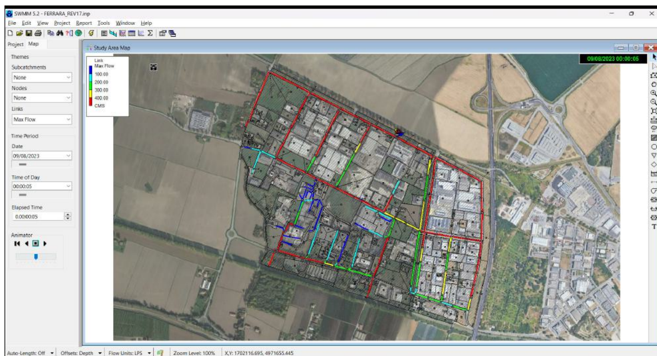
Fig. 51 – Rete fognaria – Portate massime nei singoli rami (l/s)
