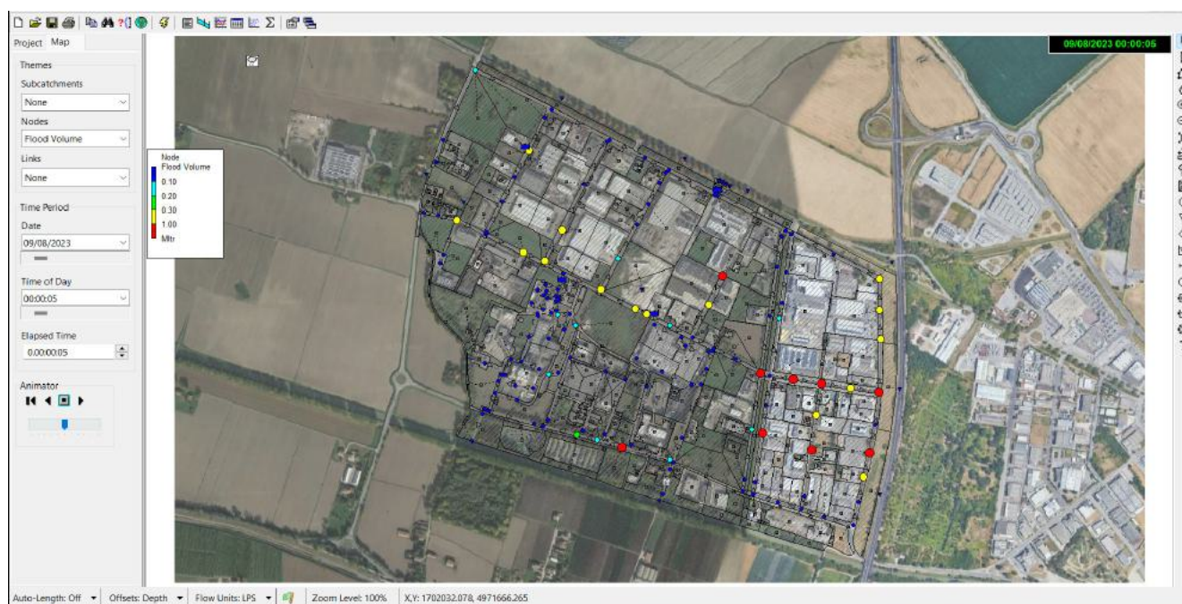
Fig. 70 – Nodi idraulici nei quali si potrebbe verificare il fenomeno del “flooding”
