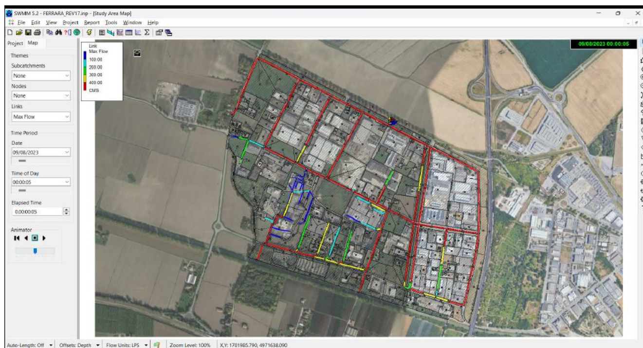
Fig. 66 – Rete fognaria – Portate massime nei singoli rami (l/s)
