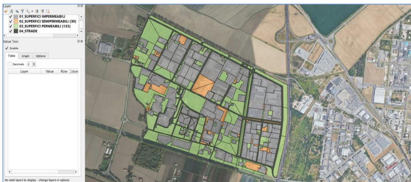
Fig. 82 – Suddivisione delle aree scolanti in impermeabili-semiimpermeabili-permeabili
