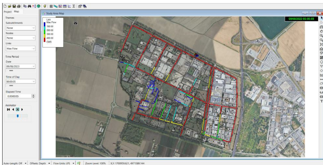
Fig. 61 – Rete fognaria – Portate massime nei singoli rami (l/s)
