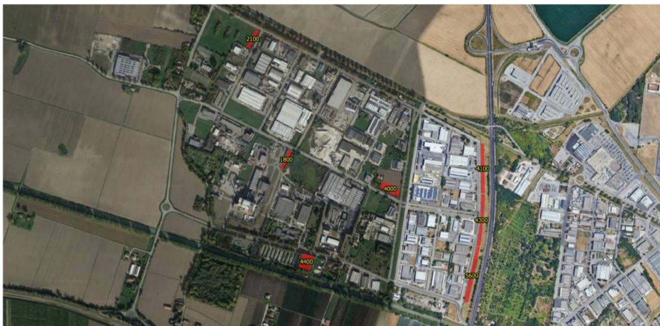
Fig. 94 – Estratto planimetria GIS posizionamento volumi di laminazione
