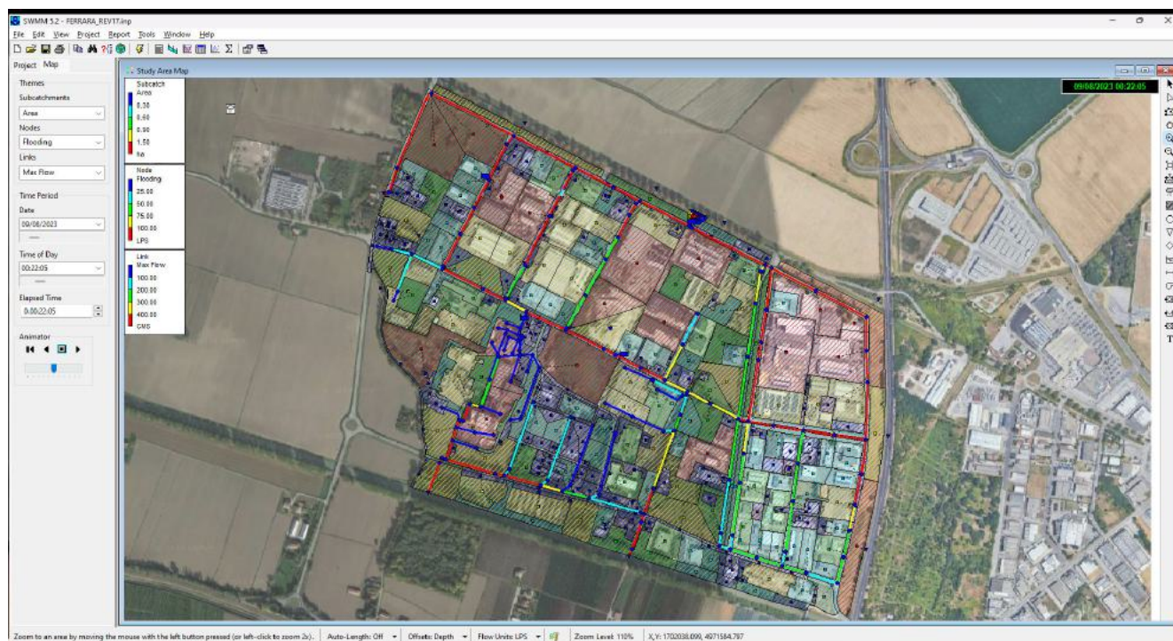
Fig. 45 – Rete fognaria – Portate massime nei singoli rami (l/s)
