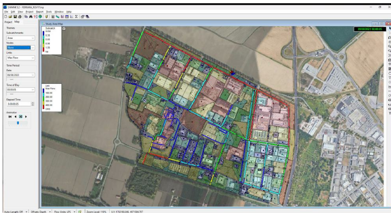
Fig. 39 – Rete fognaria – Portate massime nei singoli rami (l/s)
