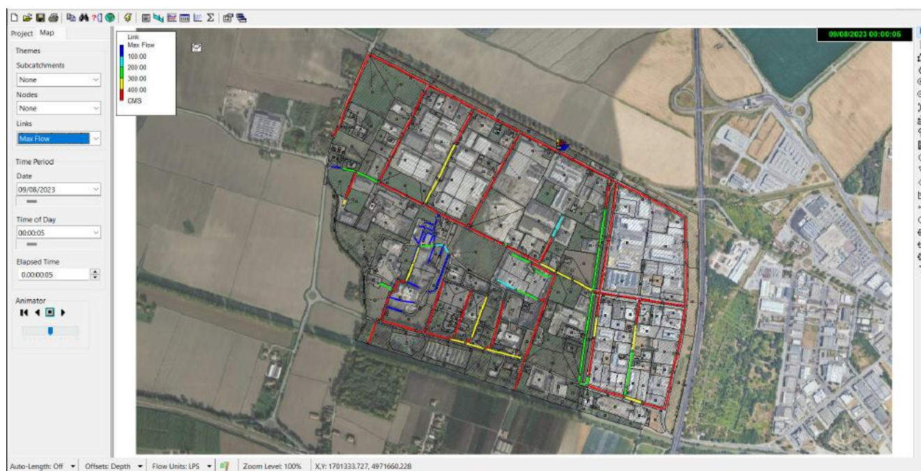
Fig. 71 – Rete fognaria – Portate massime nei singoli rami (l/s)
